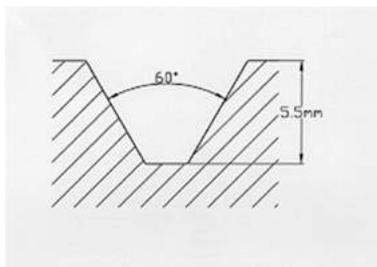
2.5 En el área de control, la superficie ocupada por surcos de al menos 1.8mm de profundidad, con un ángulo máximo de 60° entre los bloques en sección (diagrama) y 2mm de ancho, tiene que ocupar al menos el 21.5% de la superficie total.
